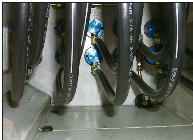
Joints Tournants Deublin 1117 sans roulement sur ligne transfert automobile.
