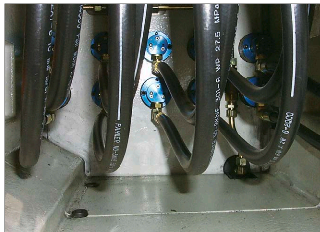
Junta rotativa Deublin sin rodamientos serie 1117 en una máquina Transfer de automoción.
