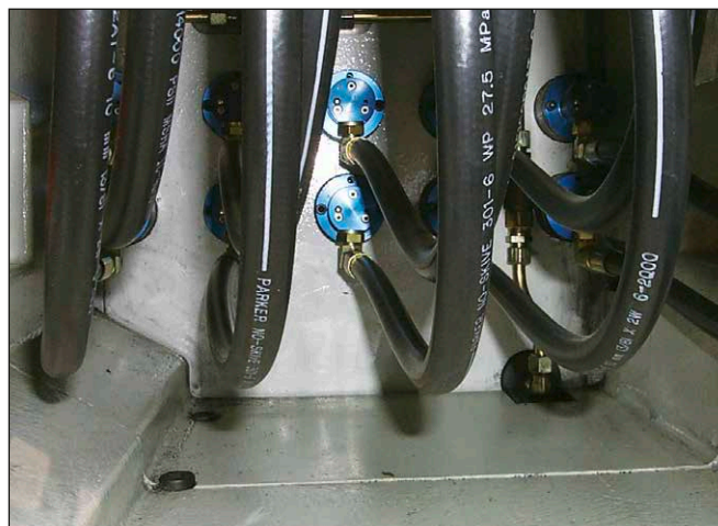
Bezložiskové přívody Deublin 1117 na automobilovém přenosovém potrubí.
