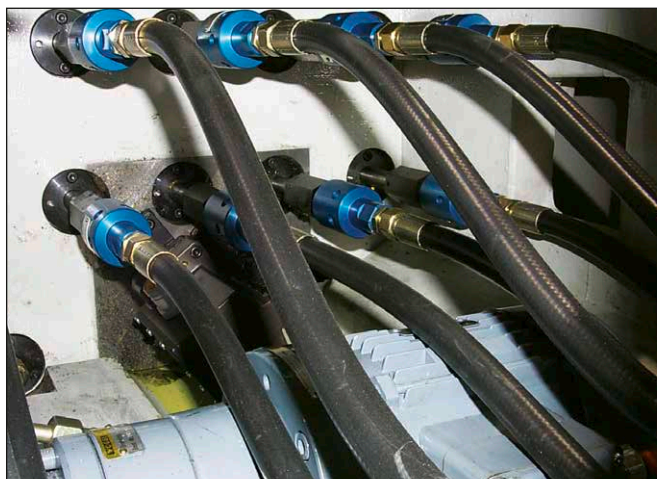
Přívody Deublin 1116 s podporou těsnění na automatické výrobní lince.
