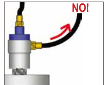
ドレンホースが 上向きになっている
