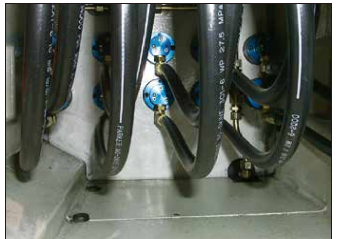
自動車用トランスファーラインに取付けられた1117ベアリングレス型ユニオン
