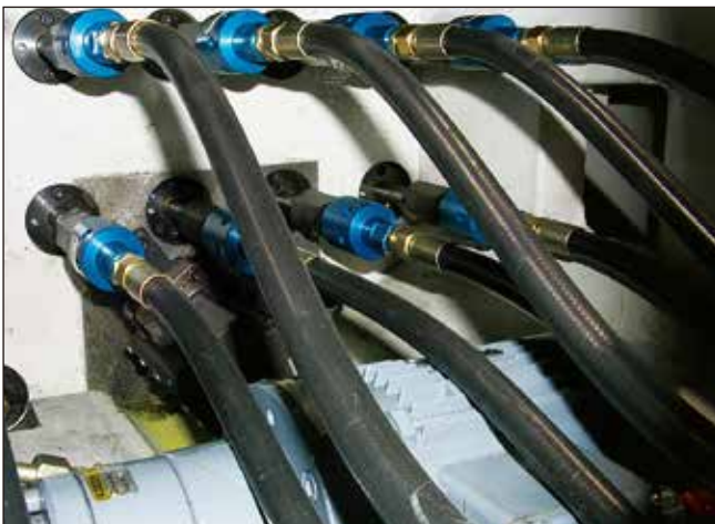
自動車用トランスファーラインに取付けられた1116ベアリング一体型ユニオン
