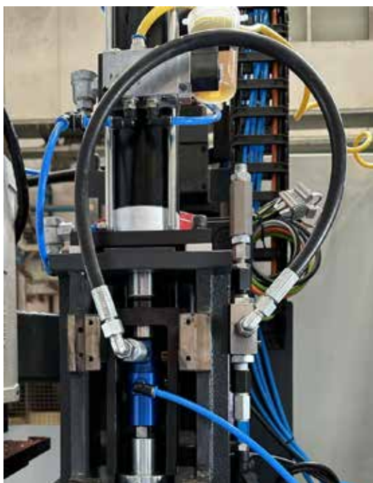
立型マシニングセンターに取付けられた 一体型ユニオン
